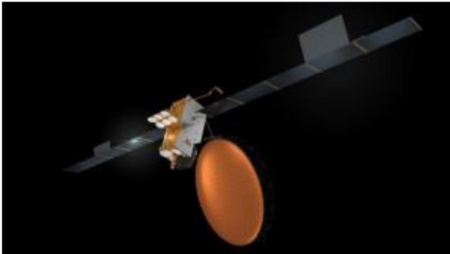
El Inmarsat-6 será completamente eléctrico, sin requerir propulsión química, aumentando así la potencia de procesamiento de banda L y suministrando la capacidad de carga útil de banda Ka.
